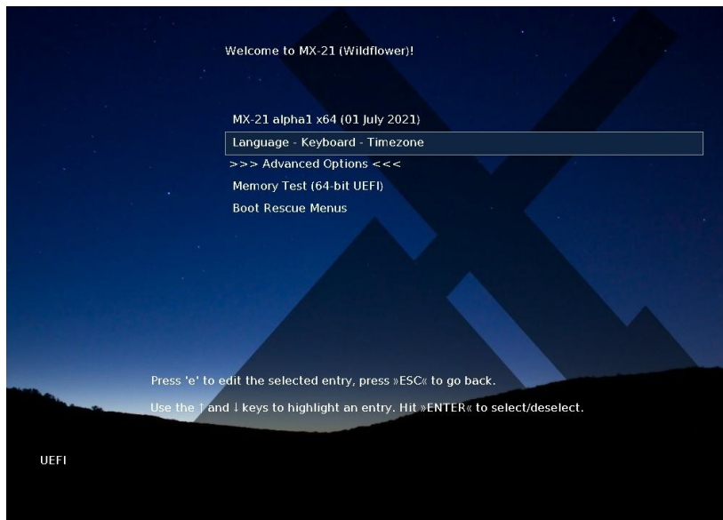
Figure 2-4 : Écran de démarrage LiveMedium de x64 (MX-21 et supérieur) lorsque UEFI est détecté
